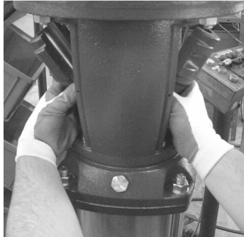
Mitnehmerstift und Kupplungshälften einbauen
